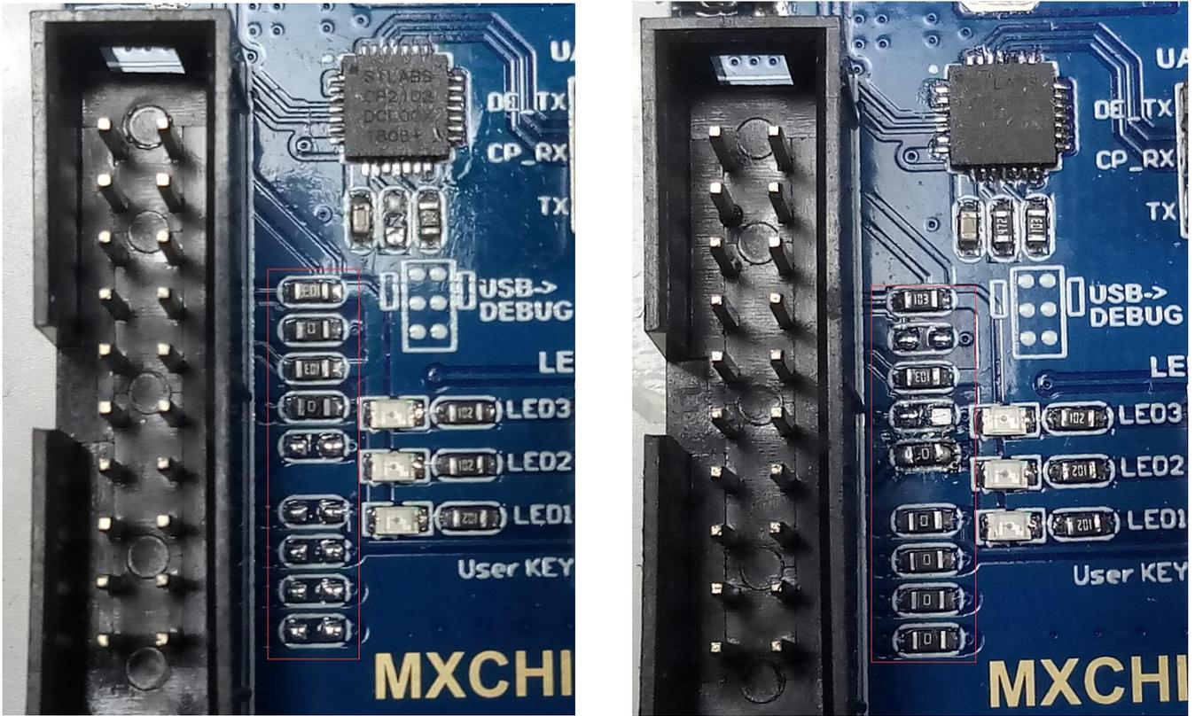
左边的图电阻焊接方式表示支持 EMW3080、EMW3031、EMW3239、EMW3166、EMW3165；
